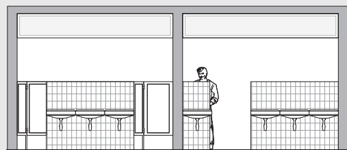
Figura N° 13: Transparencia de zonas de uso común hacia circulaciones, para permitir control visual, sin impedir privacidad en la ocupación de recintos.
